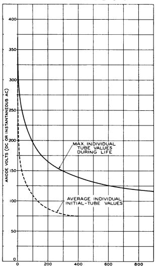
STARTER-ELECTRODE MICROAMPERES (DC OR INSTANTANEOUS AC)
